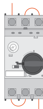
Подключение однофазного двигателя
