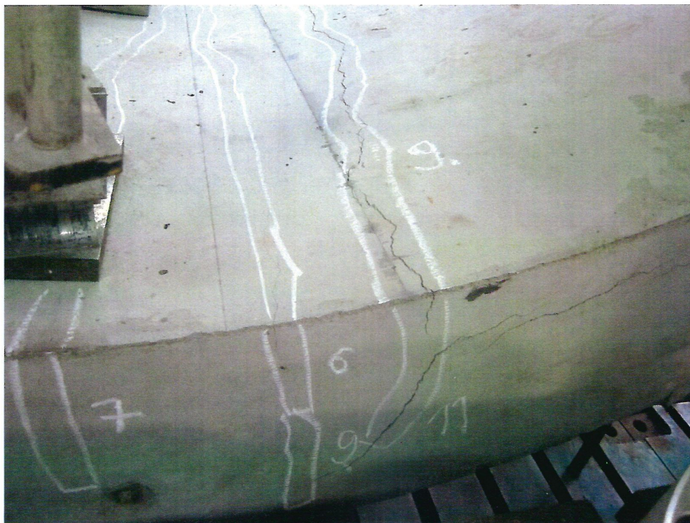
Фото 3. Характер развития радиальных трещин в нижнем сечении фрагмента №1 ж/б трубы 200/250.10-313/15000.
