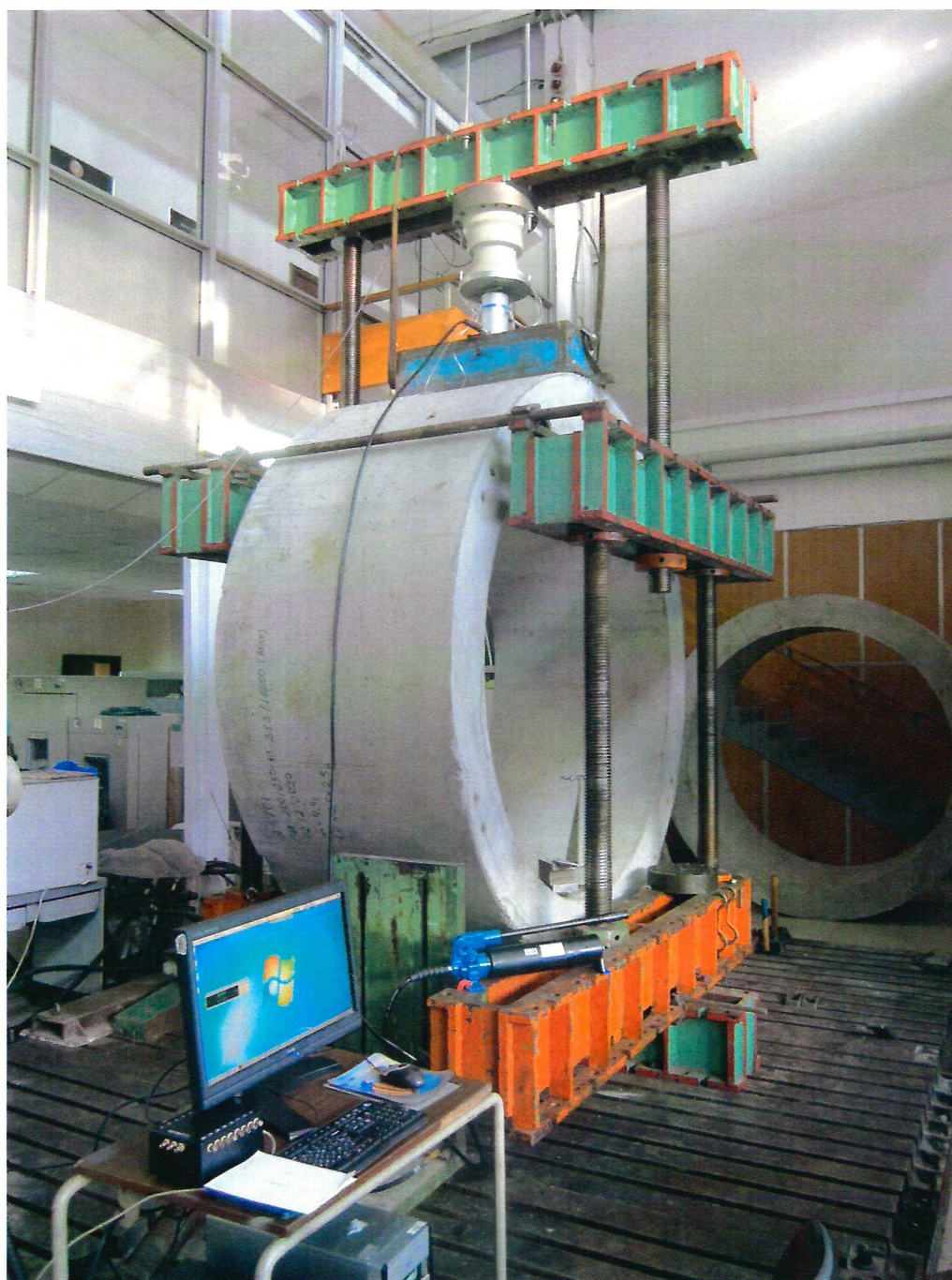
Фото 1. Стенд для испытаний железобетонных труб на прочность и трещиностойкость.
