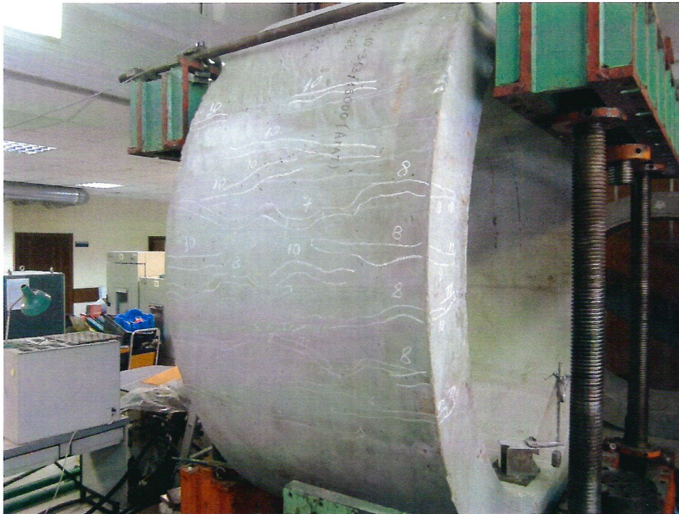
Фото 2. Характер развития трещин на боковой поверхности фрагмента №1 ж/б трубы 200/250.10-313/15000 (цифры обозначают номер ступени нагружения при которой произошло образование трещин).
